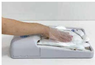
センサーが感知してグローブに空気を押し込んで膨らみますので、グローブに手を差し込みます。
