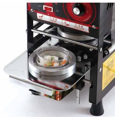
**step 5** カップをセットして、カップホルダーを奥まで押し込みます。
